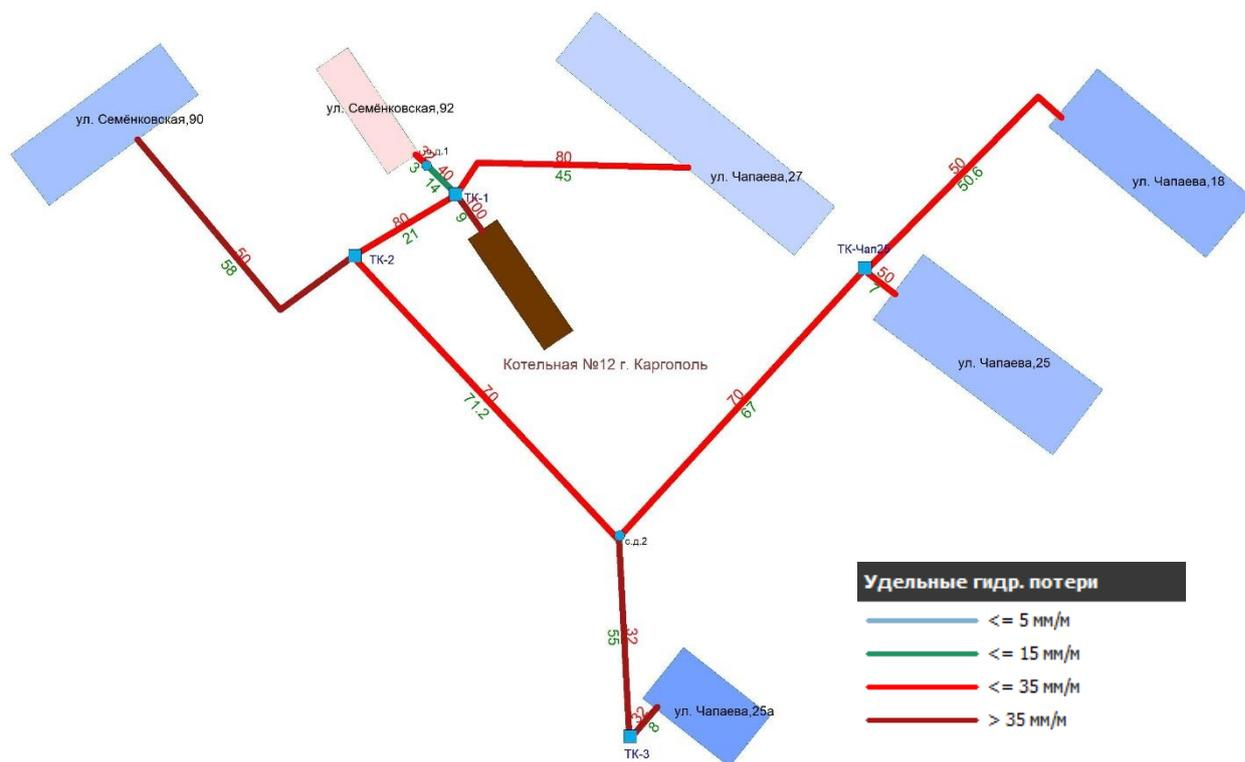
**Рисунок 1.6.2.1 - Гидравлические расчеты участков тепловой сети
