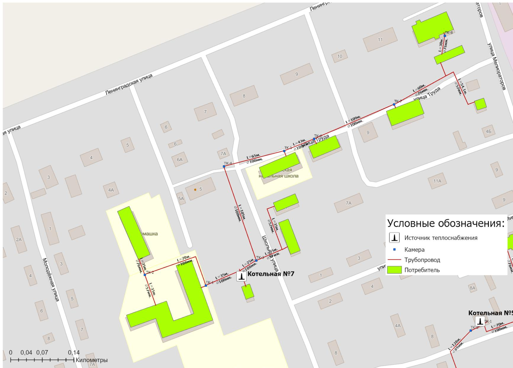
Рисунок 1.3.1.9 - Схема тепловых сетей котельная №7 п. Пригородный
