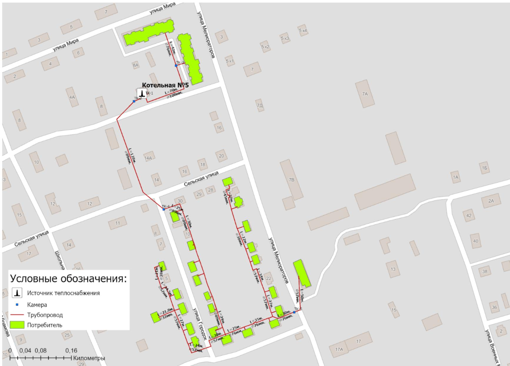
Рисунок 1.3.1.4 - Схема тепловых сетей котельная №5 г. Каргополь
