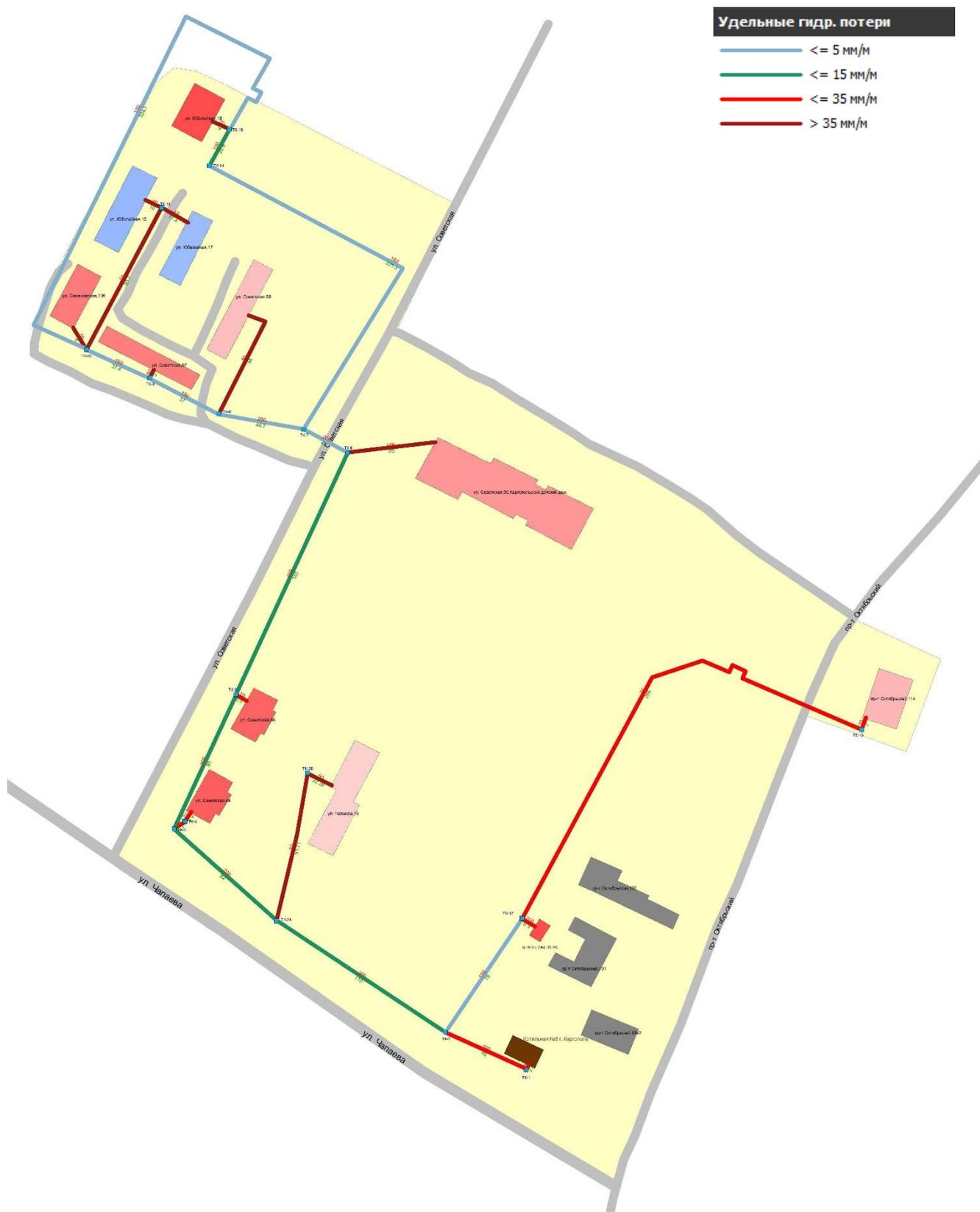
Рисунок 1.6.2.11 - Гидравлические расчеты участков тепловой сети
