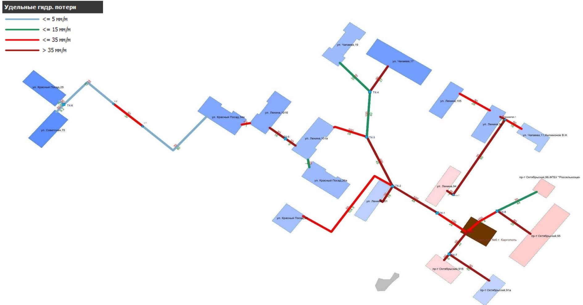
Рисунок 1.6.2.3 - Гидравлические расчеты участков тепловой сети Котельной №6 г. Каргополь
