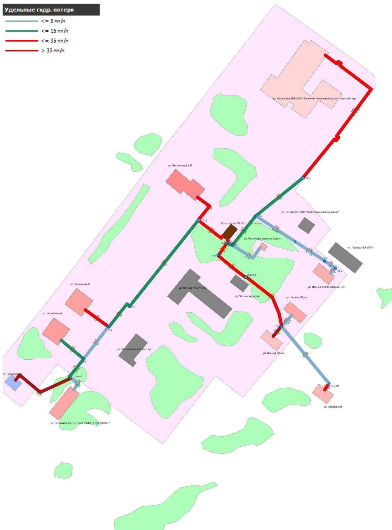
Рисунок 1.6.2.7 - Гидравлические расчеты участков тепловой сети
