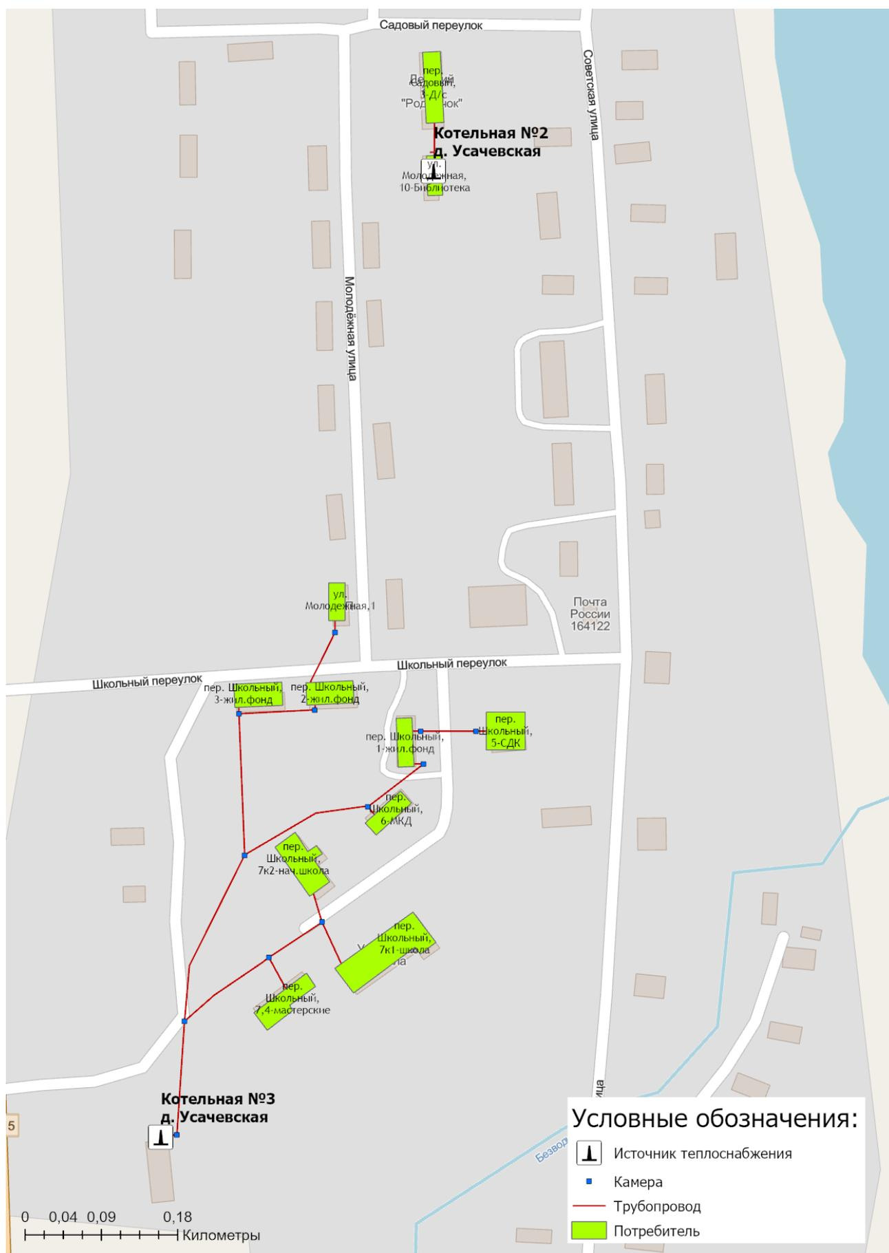
Рисунок 1.3.1.17 - Схема тепловых сетей котельная № 2 и №3 д. Усачевская
