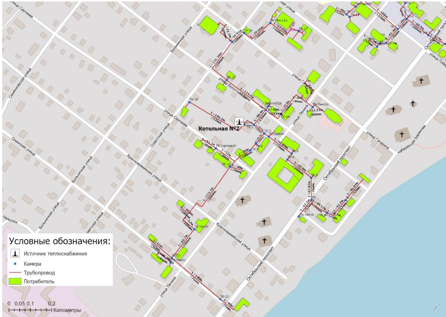
Рисунок 1.3.1.2 - Схема тепловых сетей котельная №2 г. Каргополь
