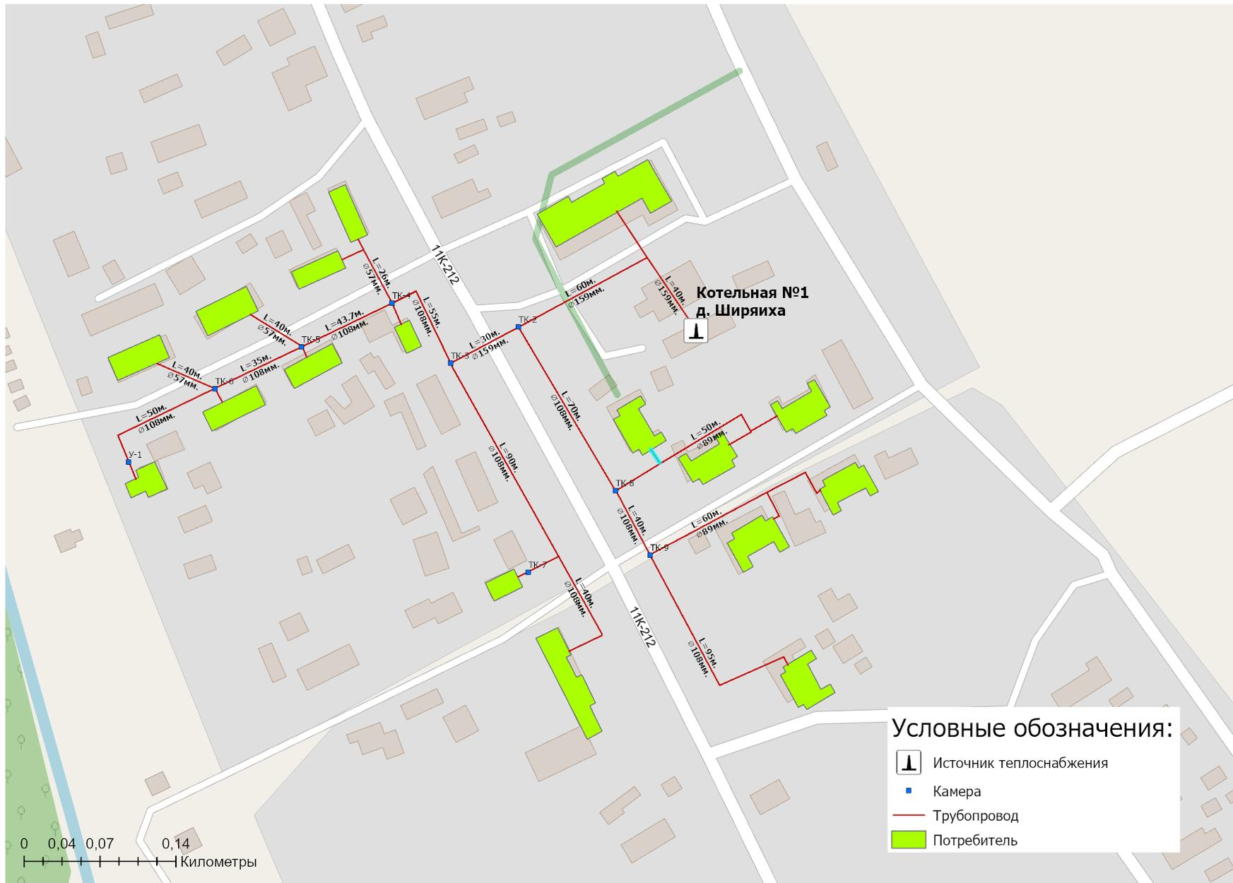
Рисунок 1.3.1.12 - Схема тепловых сетей котельная № 1 д. Ширяиха
