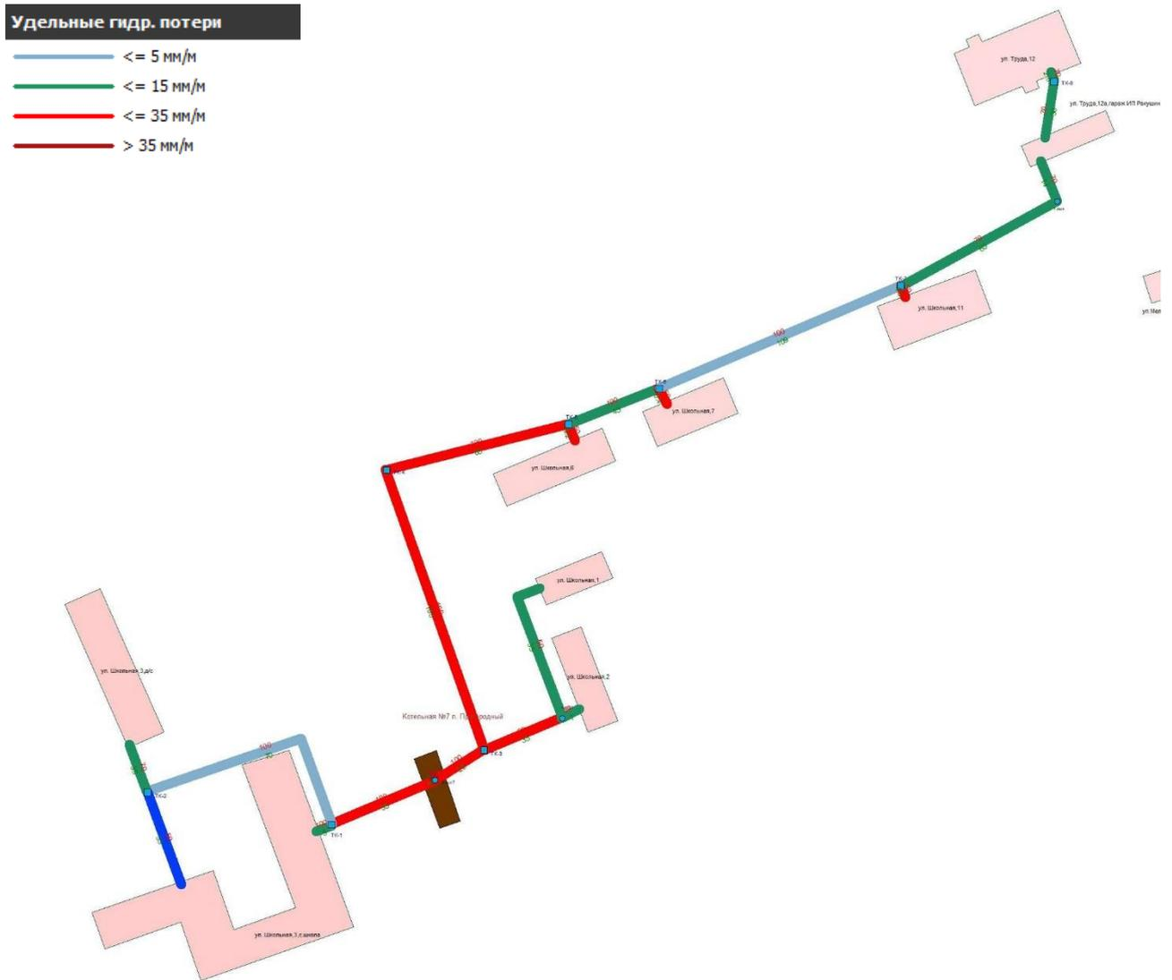
Рисунок 1.6.2.10 - Гидравлические расчеты участков тепловой сети
