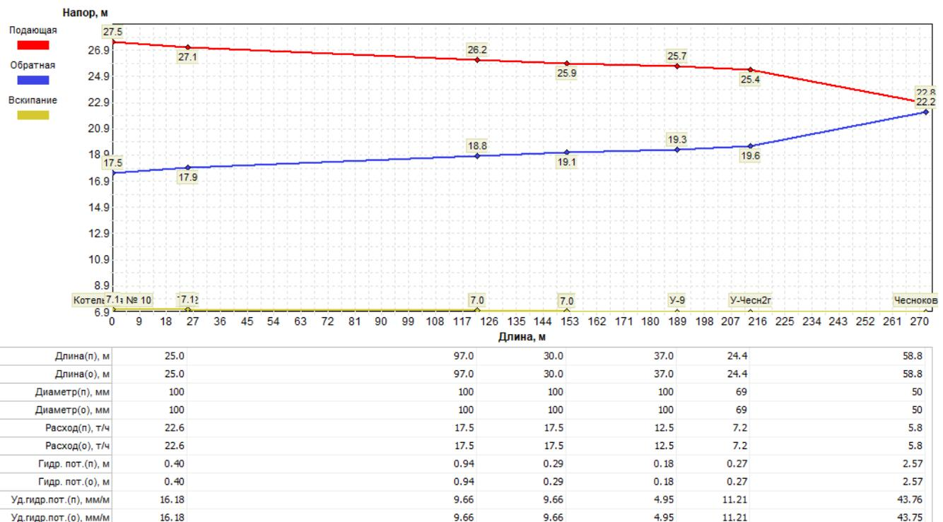
Рисунок 1.3.7.7 - Пьезометрический график участка сети Котельная №10 г. Каргополь
