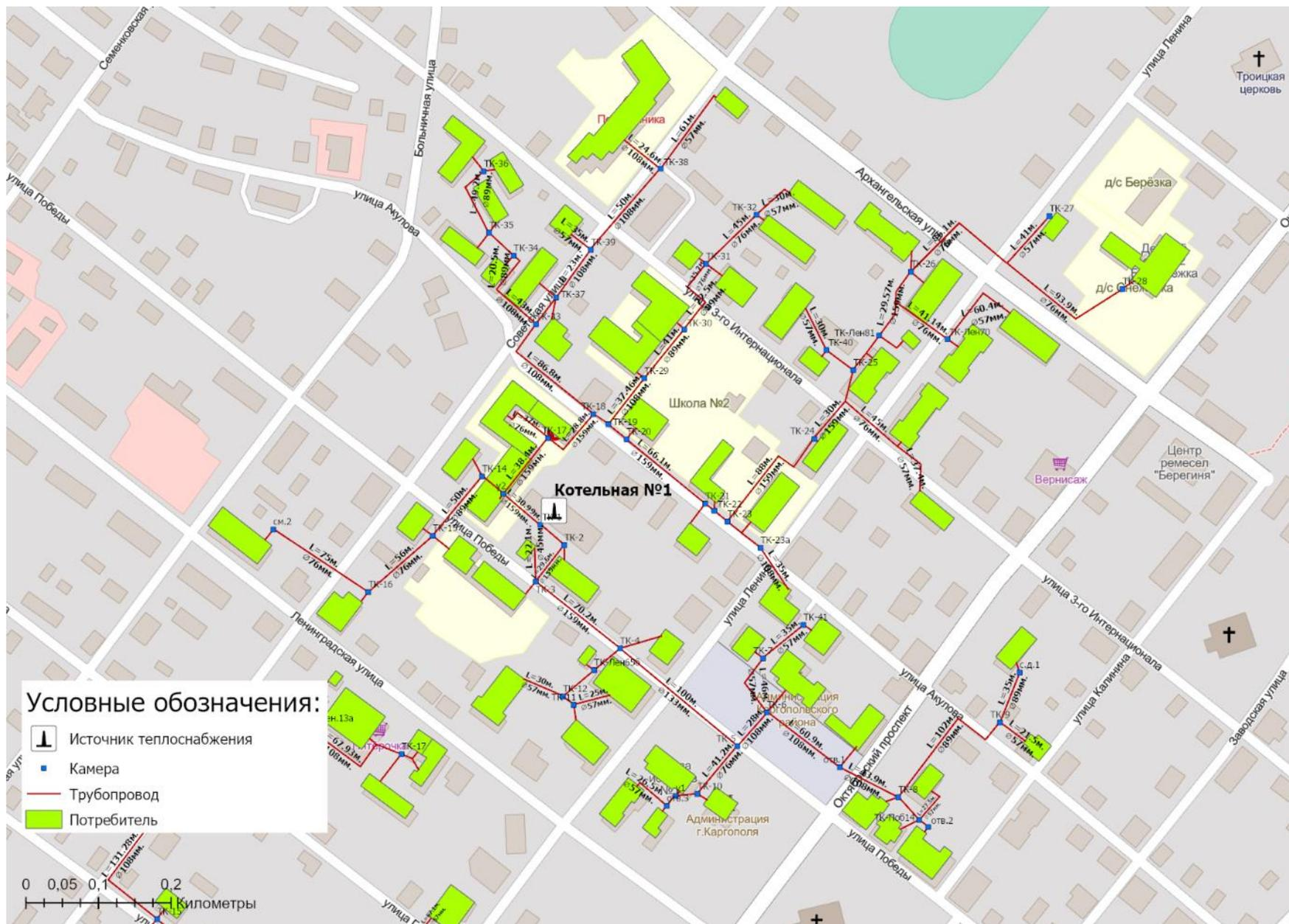
Рисунок 1.3.1.1 - Схема тепловых сетей котельная №1 г. Каргополь
