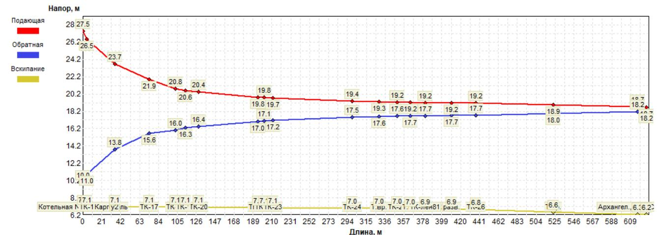
**Рисунок 1.3.7.1 - Пьезометрический график участка сети Котельная №1 г. Каргополь - ул. Архангельская (д/с Белоснежка)**
