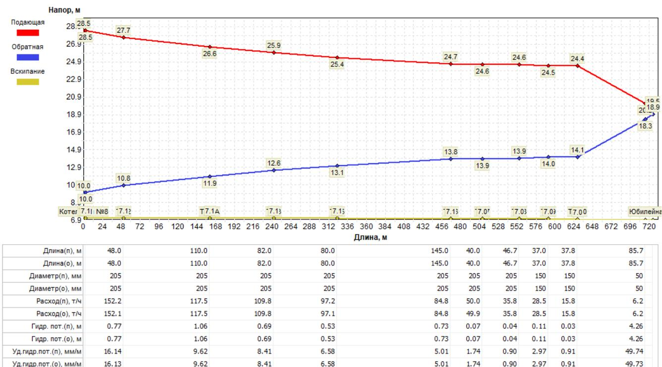
Рисунок 1.3.7.5 - Пьезометрический график участка сети Котельная №8 г. Каргополь -
