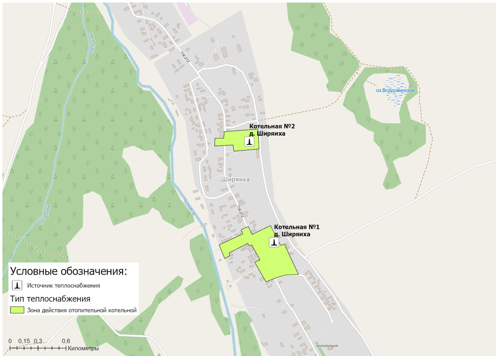
Рисунок 1.1.10 - Зона действия централизованной системы теплоснабжения на территории д. Ширяиха МО «Каргопольский муниципальный округ»
