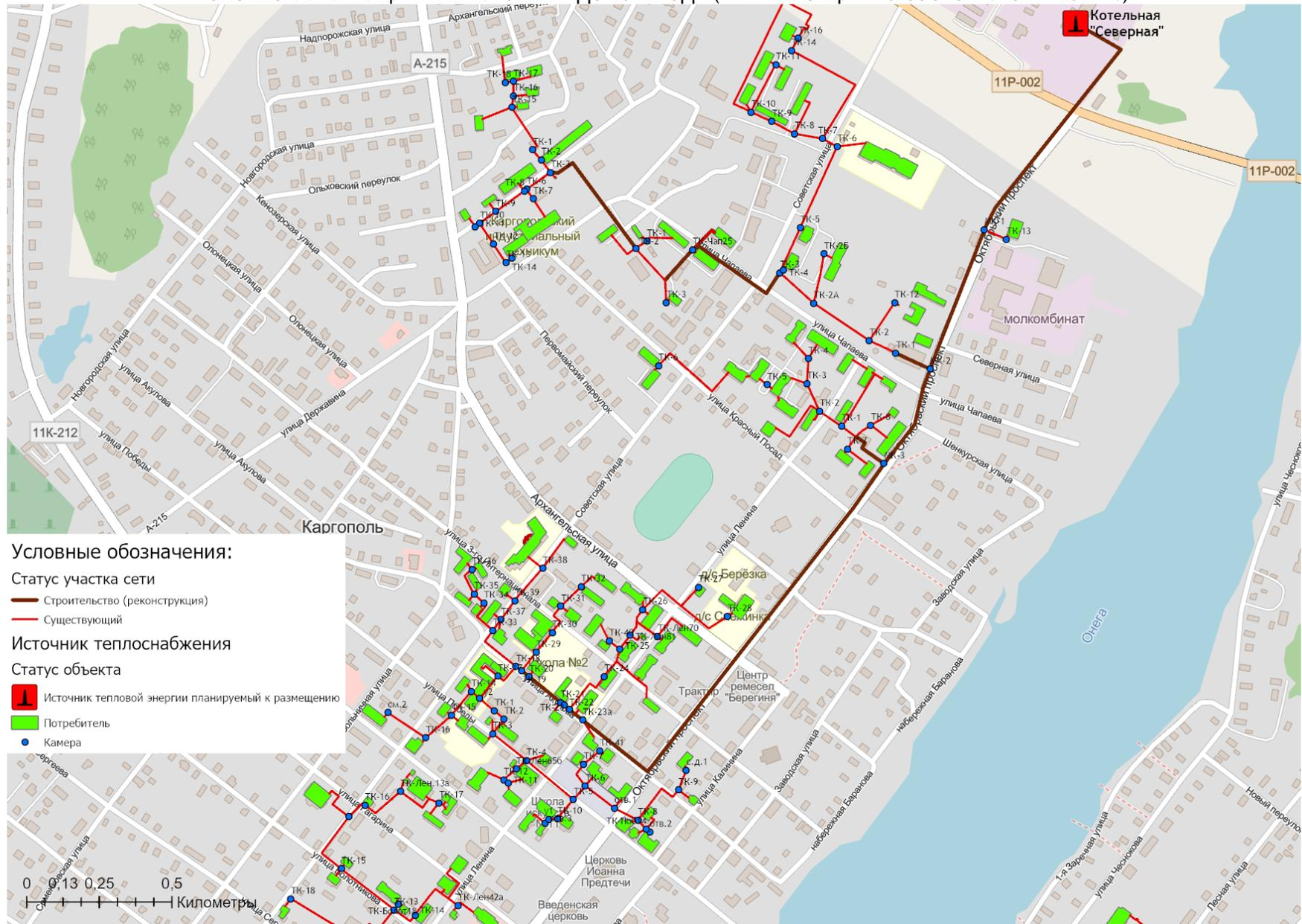
Рисунок 8.4.1 - Реконструкция тепловых сетей котельных № 1,6,8,12,КИТ с целью их объединения и подключения к вводу проектируемой котельной "Северная"
