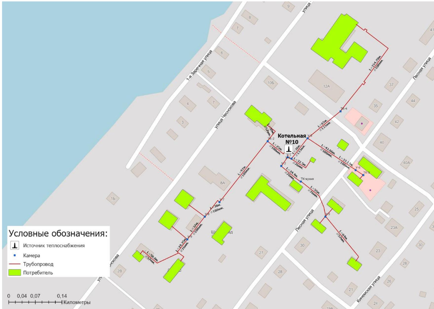
Рисунок 1.3.1.8 - Схема тепловых сетей котельная №10 г. Каргополь
