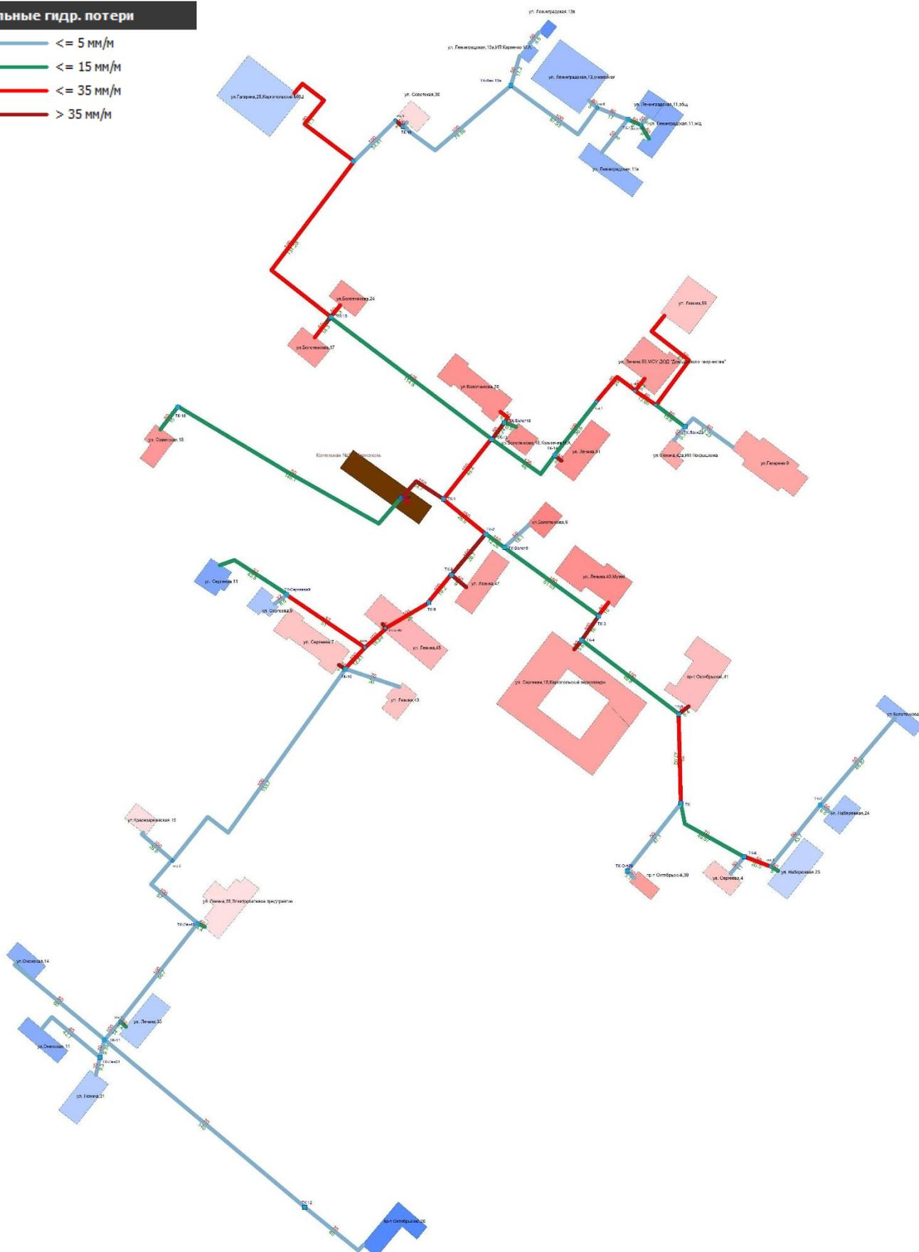
Рисунок 1.6.2.5 - Гидравлические расчеты участков тепловой сети
