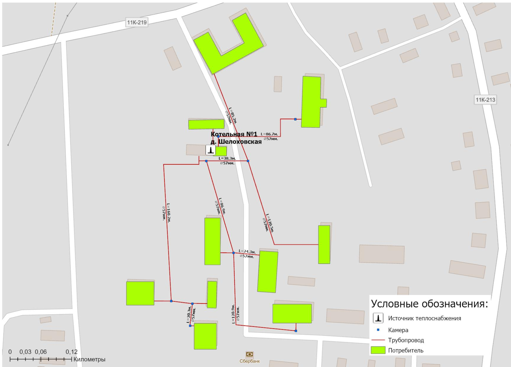
Рисунок 1.3.1.14 - Схема тепловых сетей котельная № 1 д. Шелоховская
