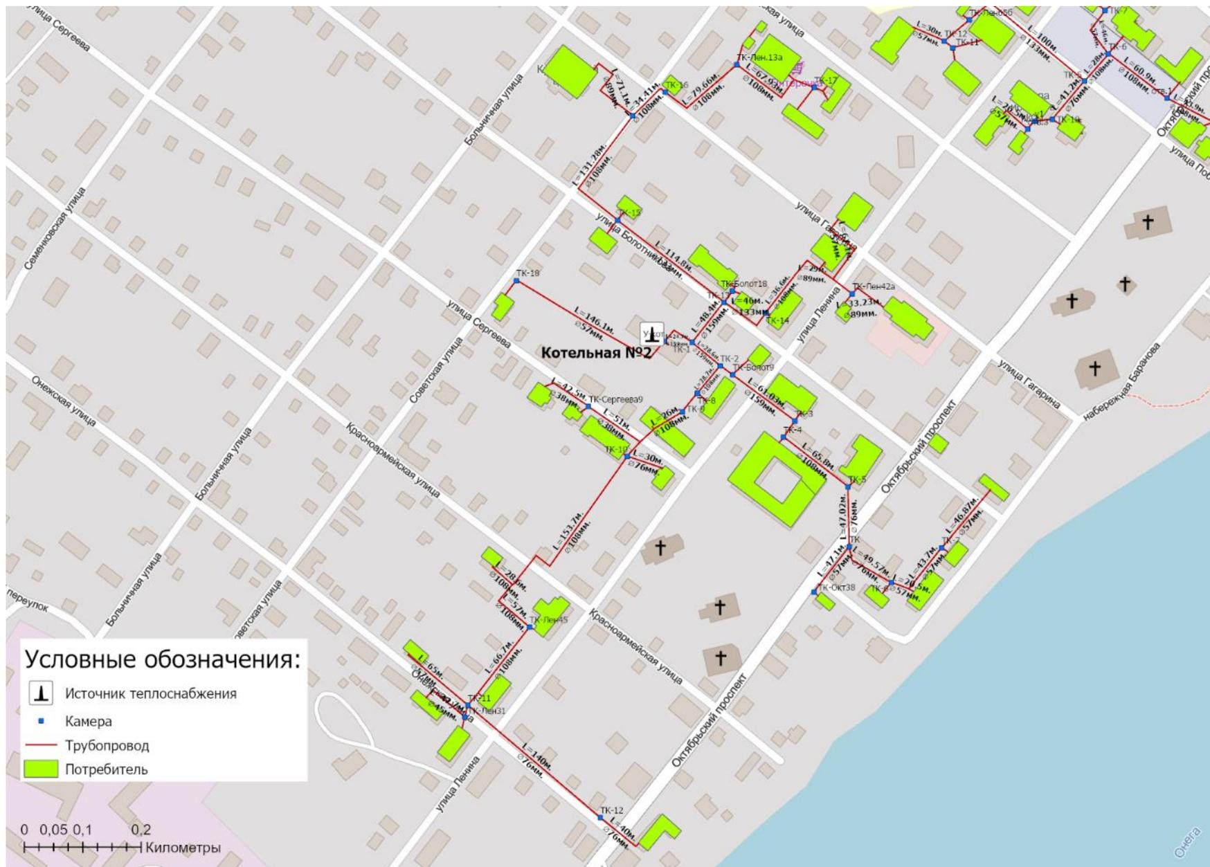
Рисунок 1.3.1.3 - Схема тепловых сетей котельная №3 г. Каргополь
