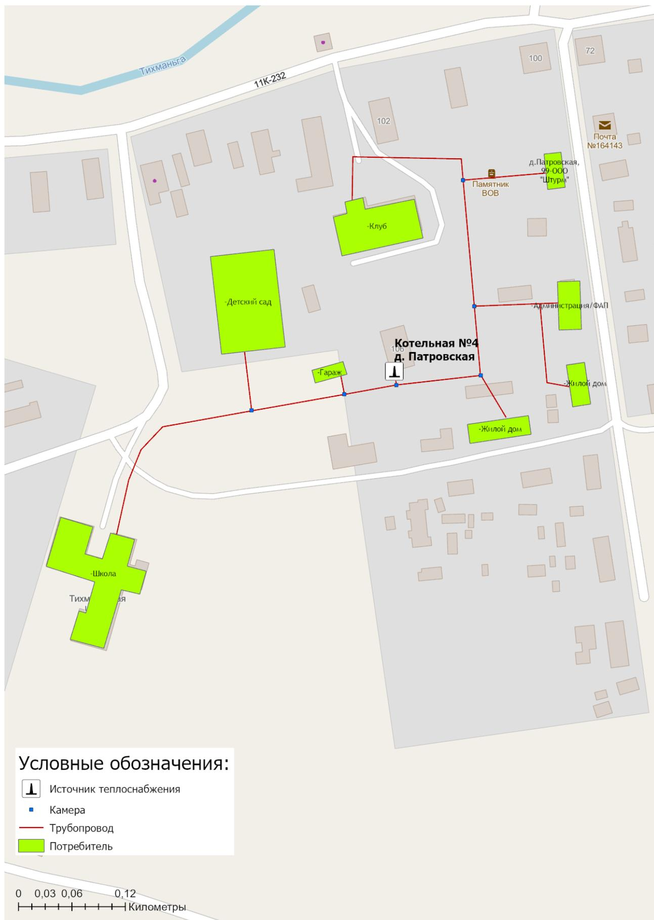
Рисунок 1.3.1.19 - Схема тепловых сетей котельная д. Патровская
