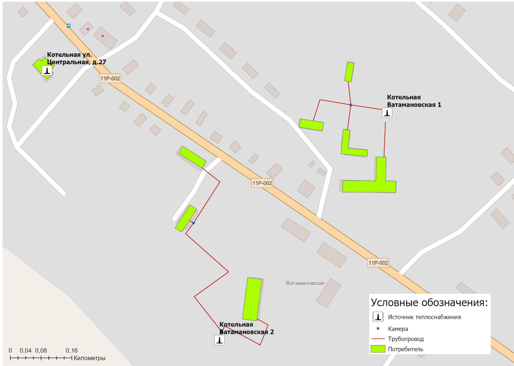
Рисунок 1.3.1.15 - Схема тепловых сетей котельная № 1, №2 и №3 д. Ватамановская
