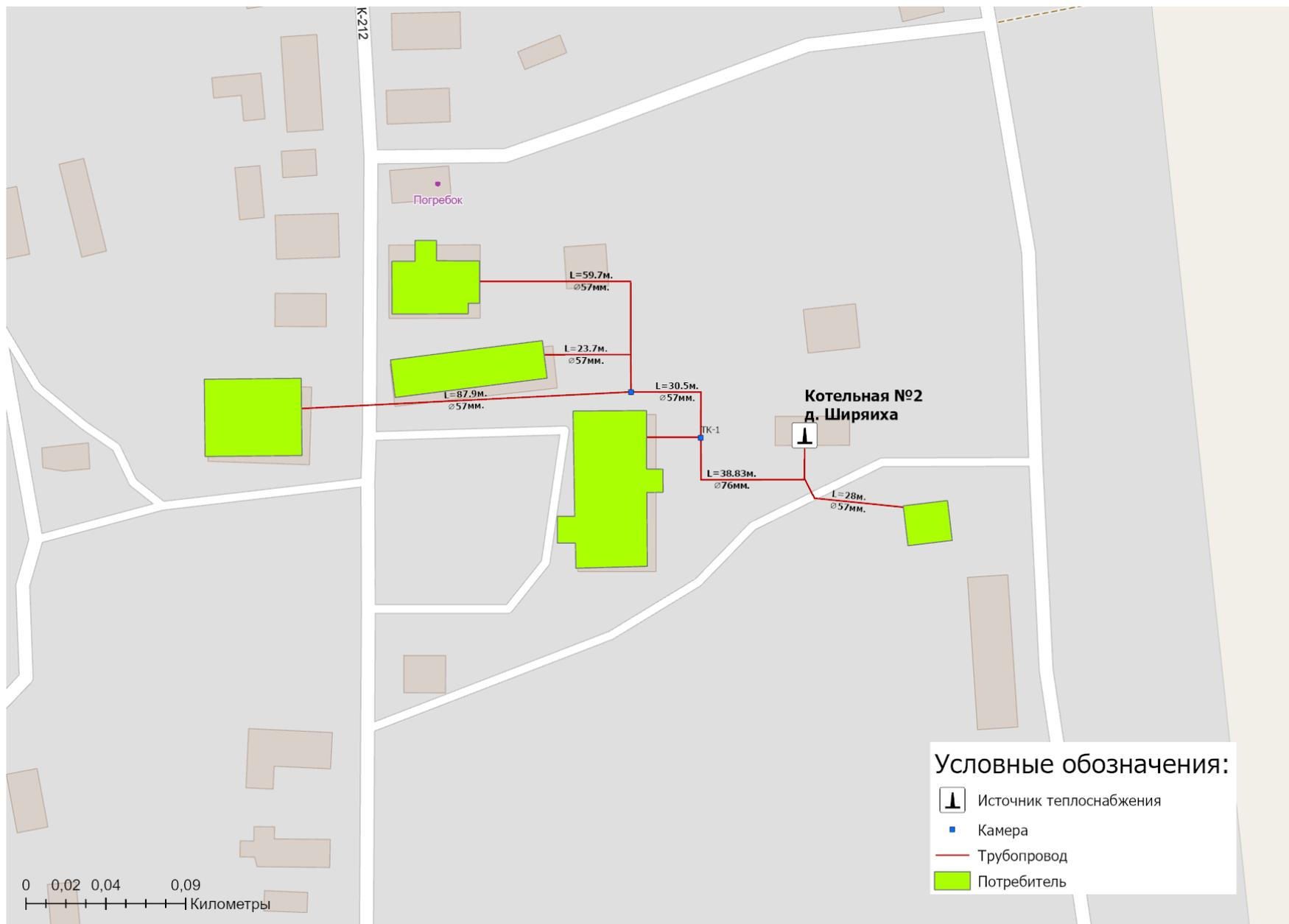
Рисунок 1.3.1.13 - Схема тепловых сетей котельная № 2 д. Ширяиха
