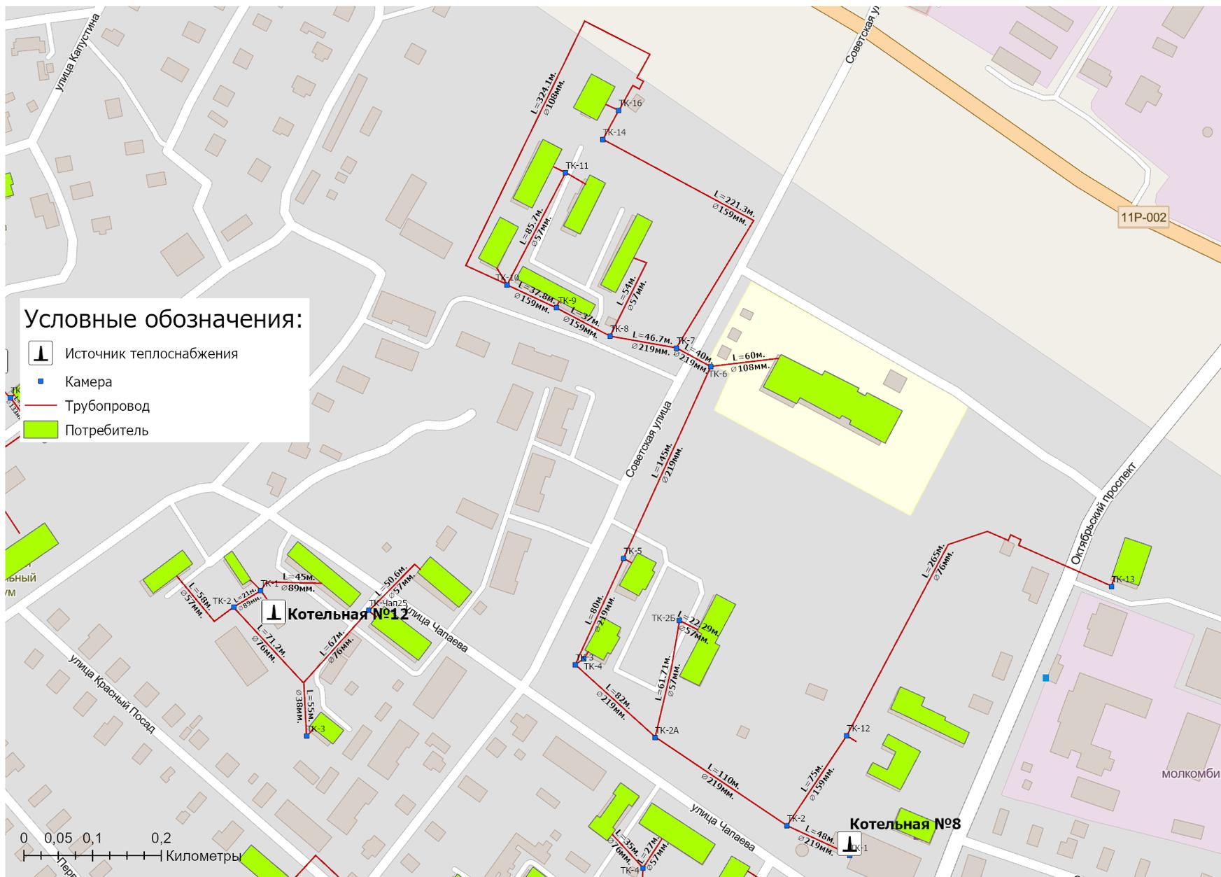
Рисунок 1.3.1.6 - Схема тепловых сетей котельная №8 и котельная №12 г. Каргополь
