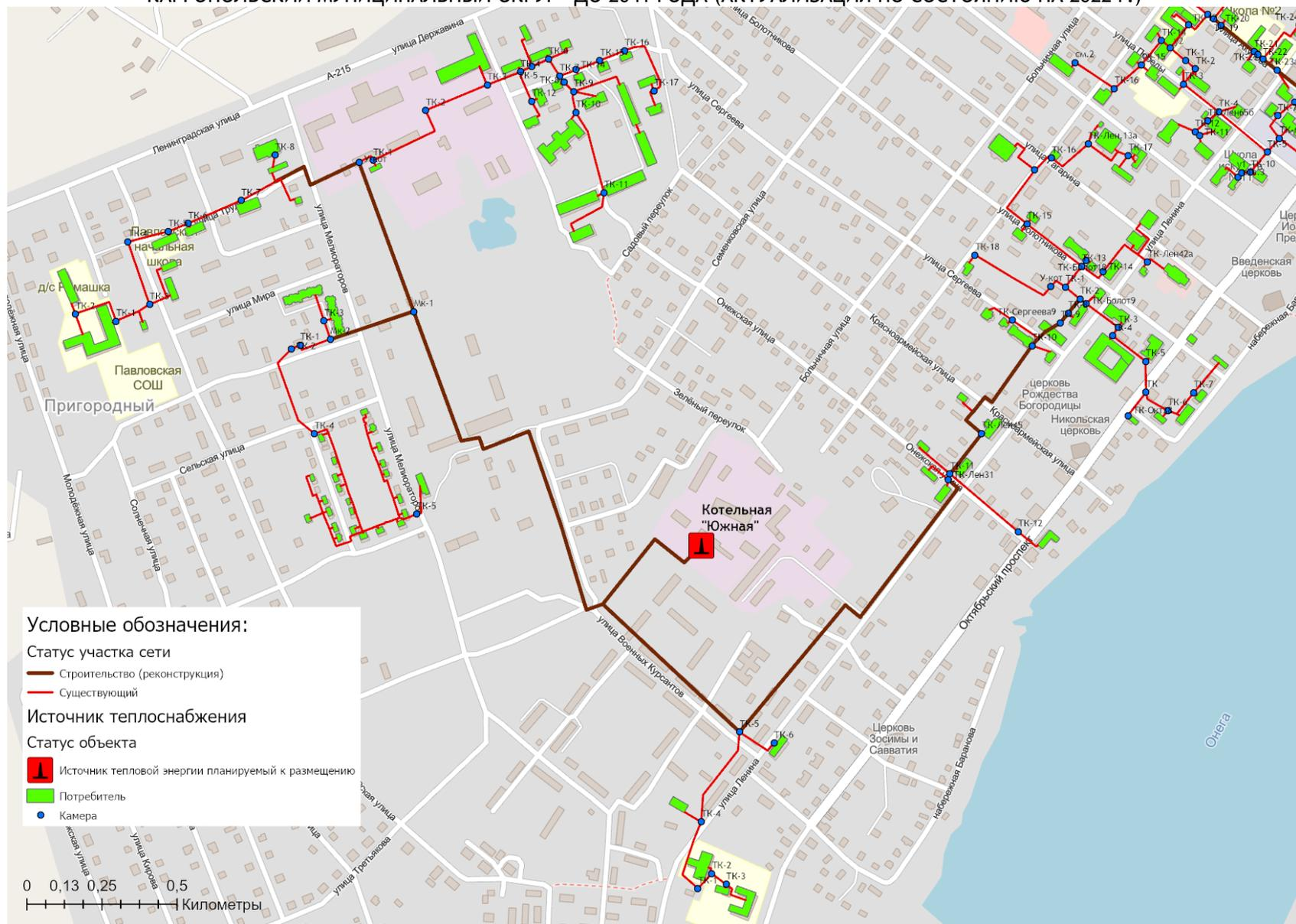
Рисунок 8.4.2 - Реконструкция тепловых сетей котельных № 9,7,5,3,2 с целью их объединения и подключения к вновь проектируемой котельной "Южная"
