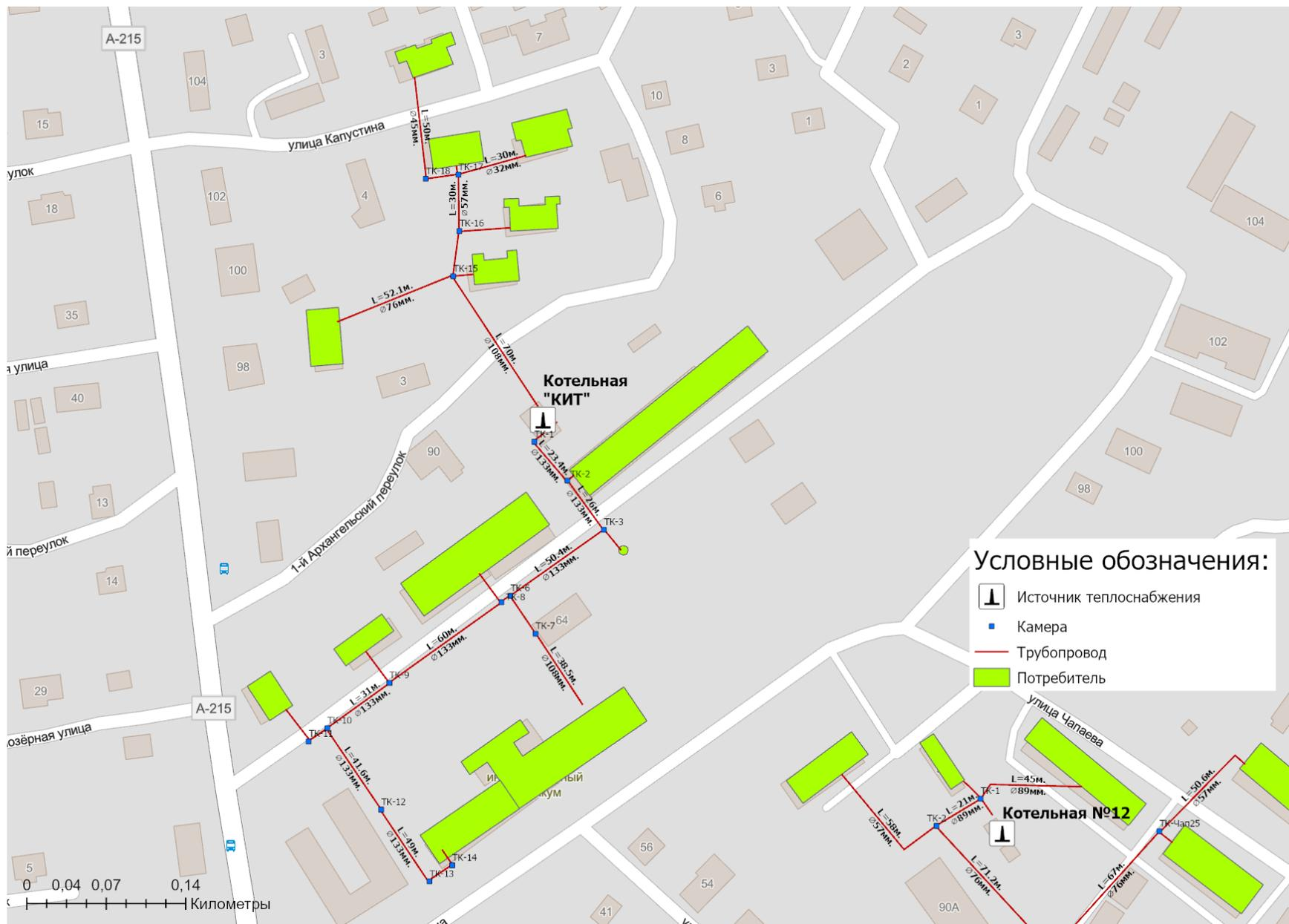
Рисунок 1.3.1.10 - Схема тепловых сетей котельная КИТ г. Каргополь
