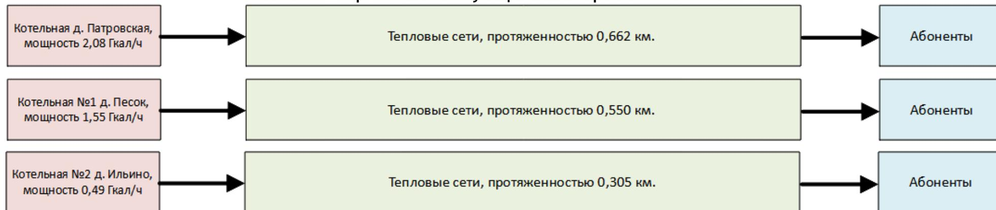
**Рисунок 1.1.1 - Функциональные схемы отопительных котельных муниципального образования «Каргопольский муниципальный округ»**
