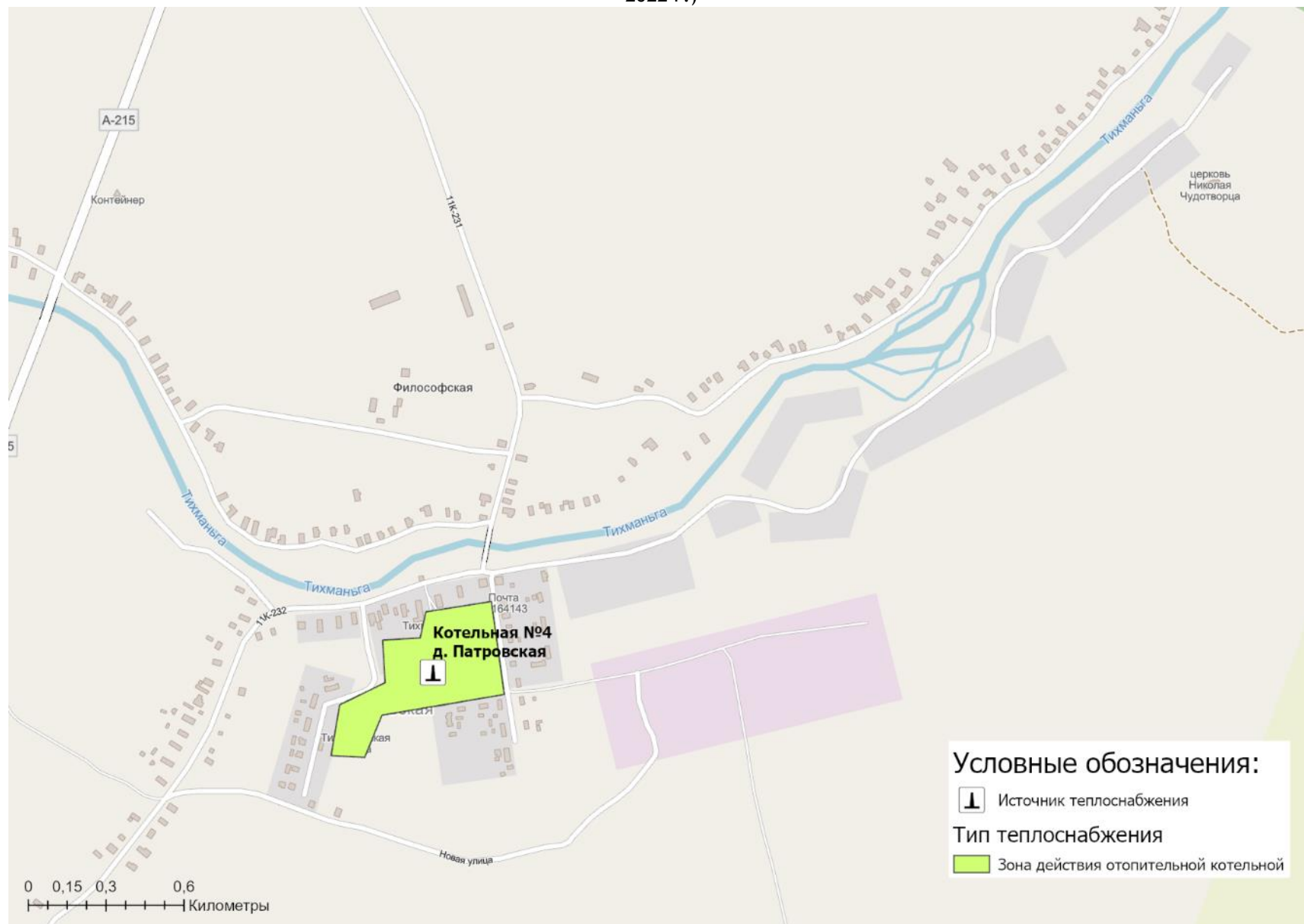
Рисунок 1.4.4 - Зона действия централизованной системы теплоснабжения на территории д. Петровская МО «Каргопольский муниципальный округ»
