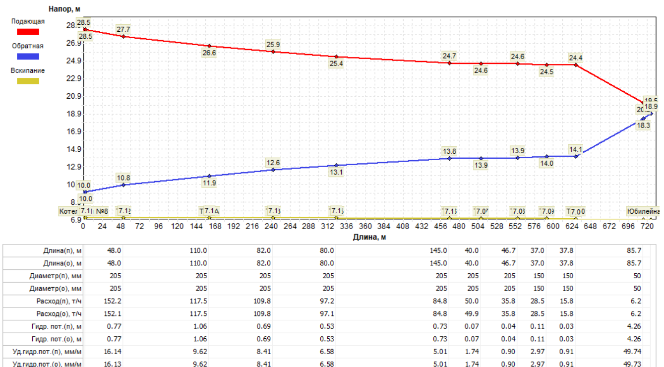
Рисунок 1.3.7.5 - Пьезометрический график участка сети Котельная №8 г. Каргополь -
